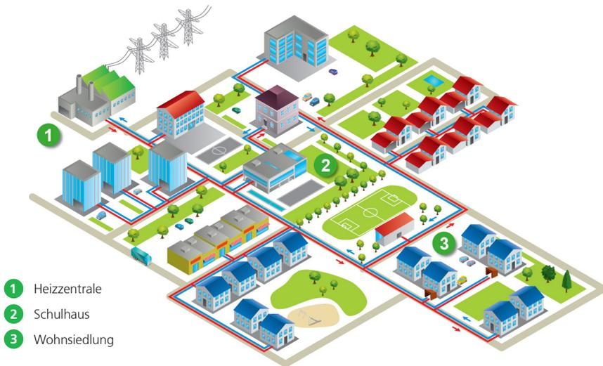
Funktionsschema eines thermischen Netzes
