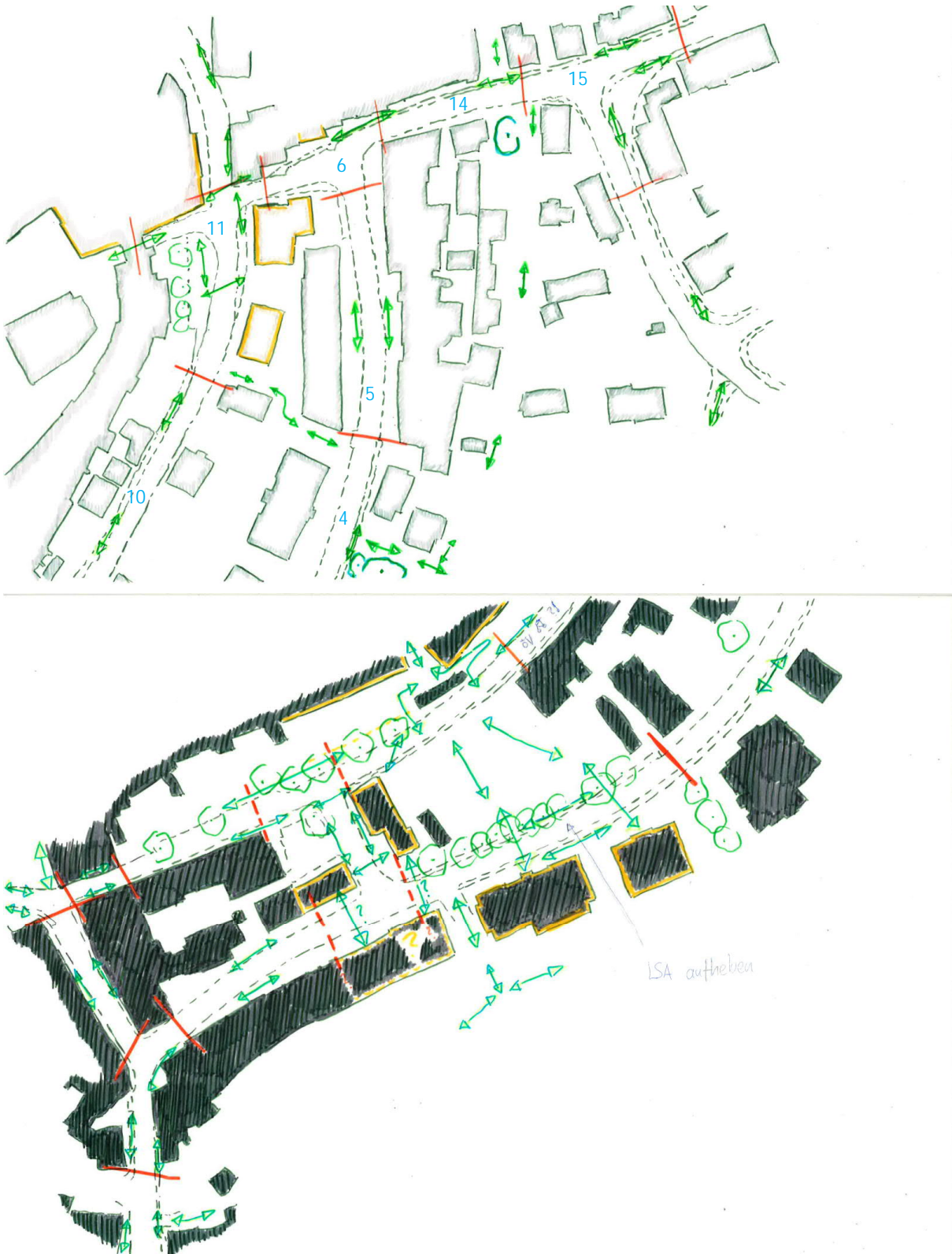
Abbildung 24: Skizze mit Abschnittsbildung, mögliche Abschnittsbildung (rot), Bauten mit öffentlicher (Erdgeschoss-) Nutzung, Quell- und Zielorte Fussverkehr (gelb), wichtige Beziehungen für den Fussverkehr (grün), Nummern bezeichnen Abschnittsbildung (vgl. Kap. 4.8.4.1 4.8.4.5), (Quelle M. Reich)
