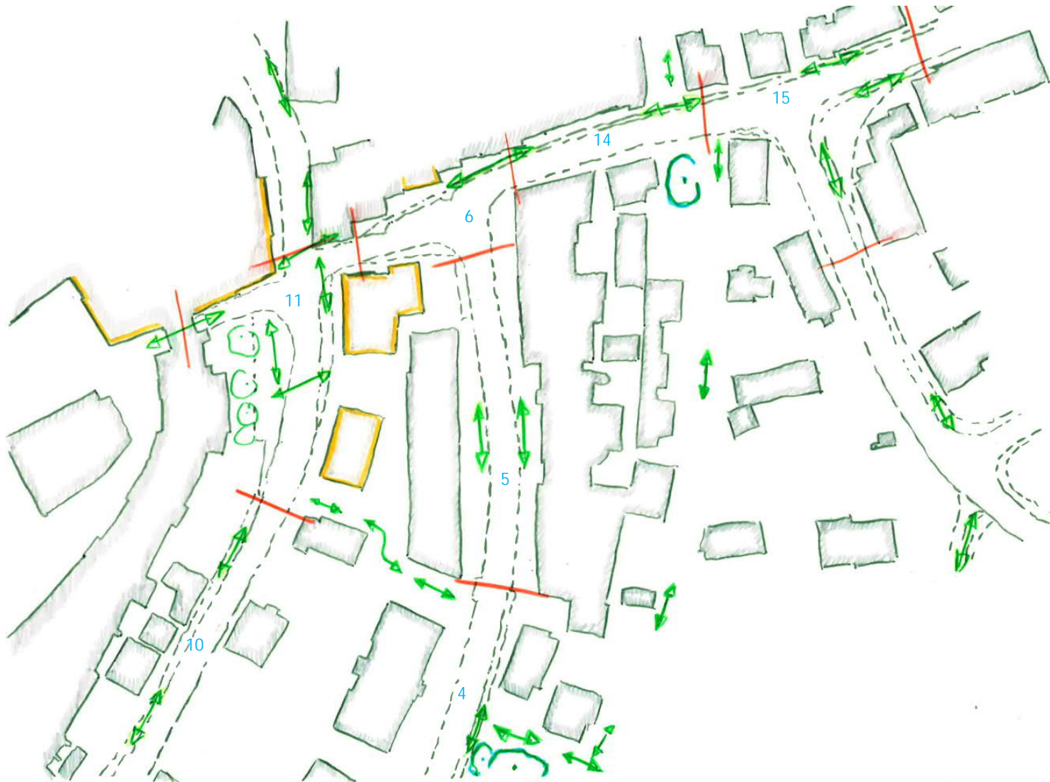
Abbildung 24: Skizze mit Abschnittsbildung, mögliche Abschnittsbildung (rot), Bauten mit öffentlicher (Erdgeschoss-) Nutzung, Quell- und Zielorte Fussverkehr (gelb), wichtige Beziehungen für den Fussverkehr (grün), Nummern bezeichnen Abschnittsbildung (vgl. Kap. 4.8.4.1 4.8.4.5), (Quelle M. Reich)
