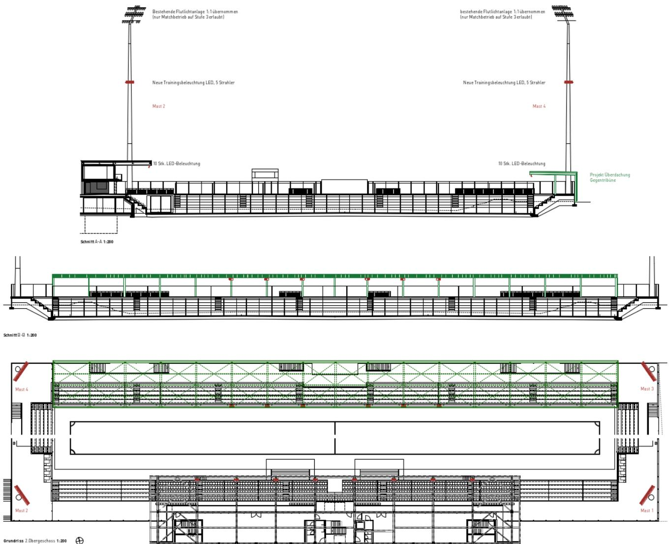
Abbildung 1: Ansicht Var. 0 (Topbeleuchtung bleibt, Ergänzung Halbmast und unter den Überdachungen) von Osten, Süden und im Grundriss. Die neue Überdachung der Gegentribüne ist in grün dargestellt.
