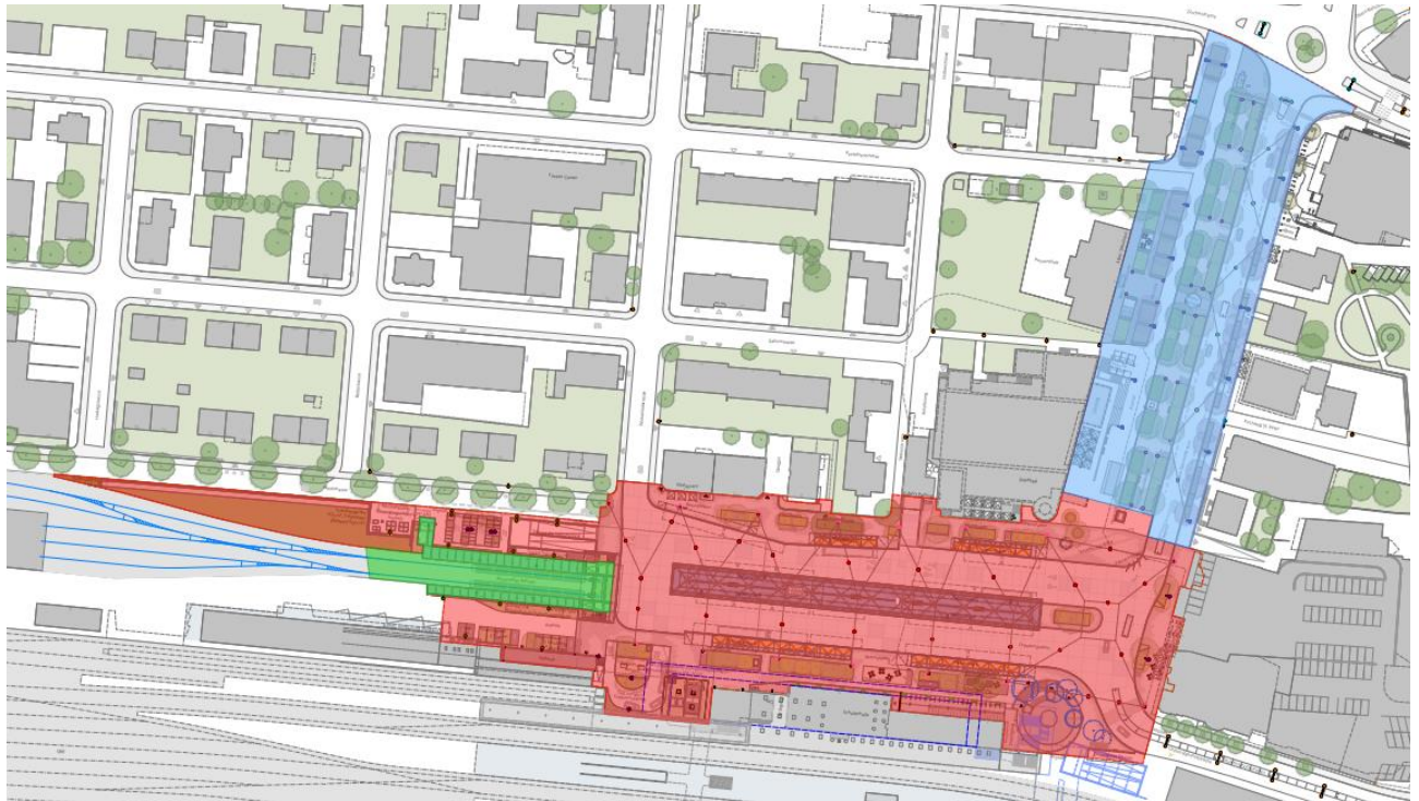
Abbildung 1: Übersicht Gesamtprojekt mit Modul 1, Bahnhofplatz mit Bushof (rot), Modul 2, Allee (blau) und Modul 3, Verschiebung Endhaltestelle AB (grün)
