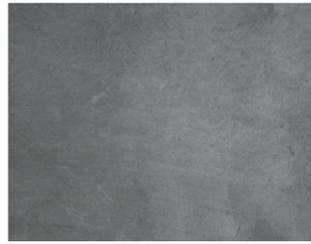
Wegen der starken Beanspruchung des Bodens ist ein robustes Material gefragt: Ein industrieller Hartbetonbelag hat dafür optimale Eigenschaften; er kann fugenlos und mit minimaler Schichtstärke eingebaut werden.
