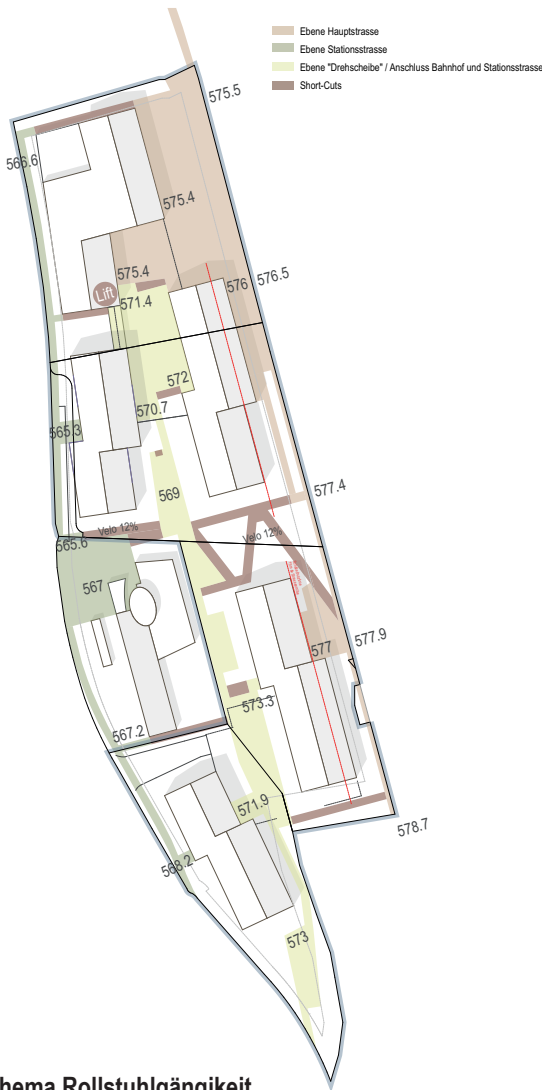
Schema Rollstuhlgängigkeit Fusswege mit terrasiertem Aussenraum und max. 6% Gefälle
