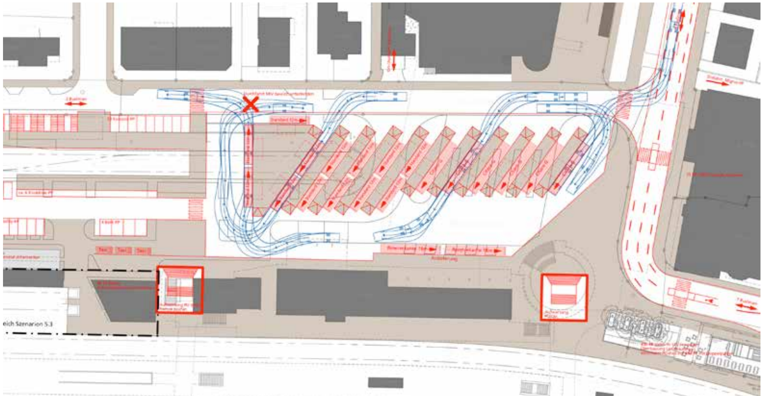
Abbildung 55: Variante 01 mit Schräganordnung Bushof, FWB nach Westen verschoben, 10.09.2014, Quelle: asa AG
